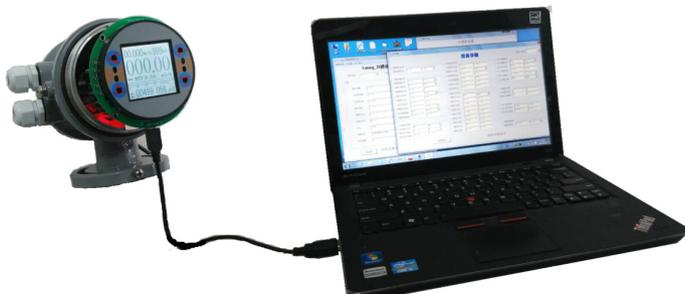
電磁流量計具有 USB 資料傳輸功能，通過 USB 介面可將儀表的斷電時間、送電時間、斷電次數、瞬間流量、累積流量，以及上、下限警報，空管和激磁警報等資訊傳到上位。(此功能為選購項)
