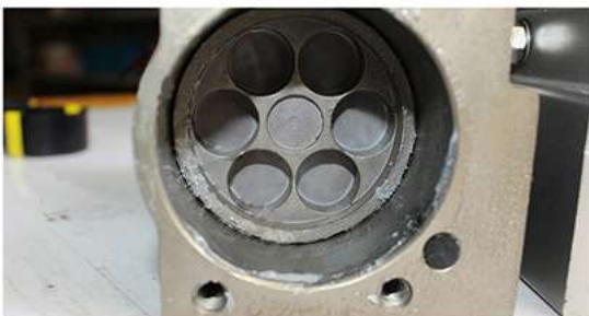
缸體與活塞均經過硬質氧化處理，光滑堅硬耐磨，壽命長扭力大。
