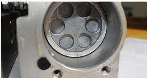
有些缸體有硬氧化，活塞沒有；大部分缸體活塞均未硬氧化處理。 PS: 硬質氧化成本高，但對於產品品質和使用壽命卻是最關鍵的。
