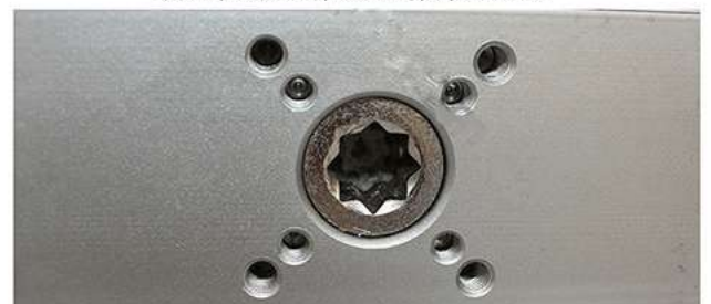
輸出軸精度低，硬度不夠，時間一長有些竟被磨成圓孔。
