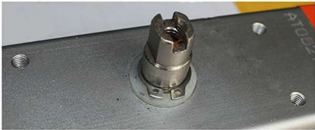
卡簧+密封圈，中軸易爆出或晃動，壽命短。
